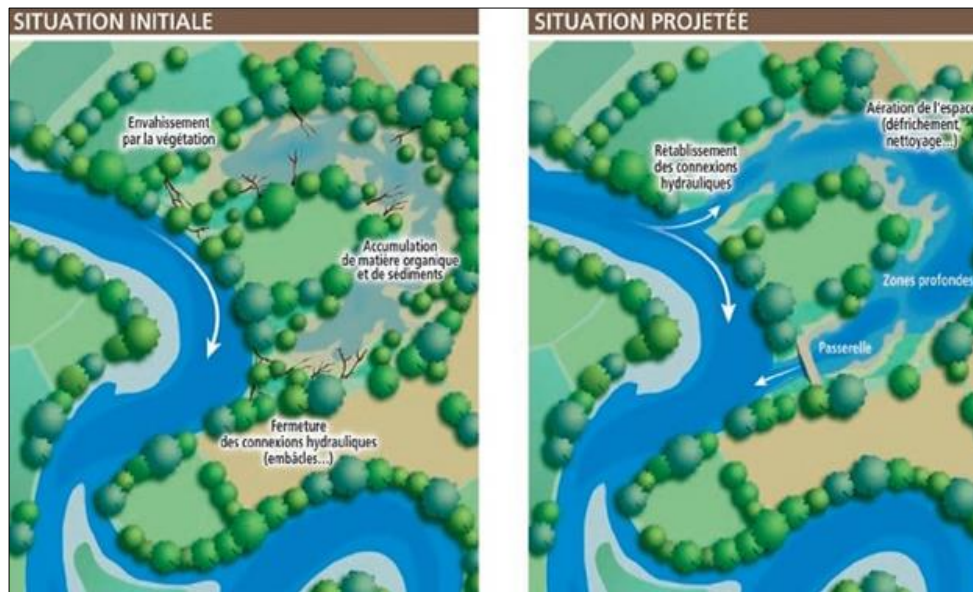
Figure 30 : Illustration reconexion d'annexe hydraulique (Source : AFB)
